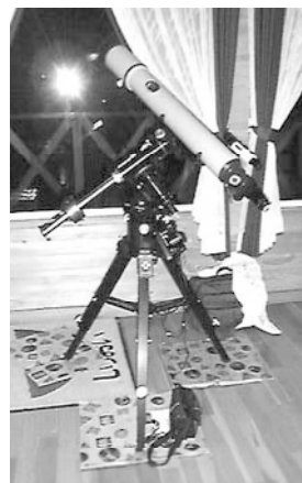
写真-6 Losmandy赤道儀に搭載された 昭和機械10 cm ED屈折望遠鏡
