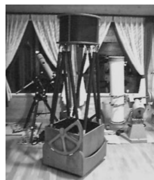
写真-6 Losmandy赤道儀に搭載された 昭和機械10 cm ED屈折望遠鏡
