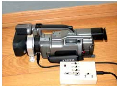
写真1 天文用に感度UP改修したビデオカメラ
