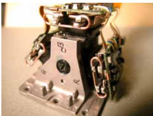
写真 6 RGB色分解プリズムとレジストレーション調整機構
