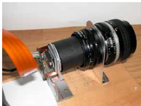
写真 17,18 本体からレンズ・TF・CCD部を分離して調整
