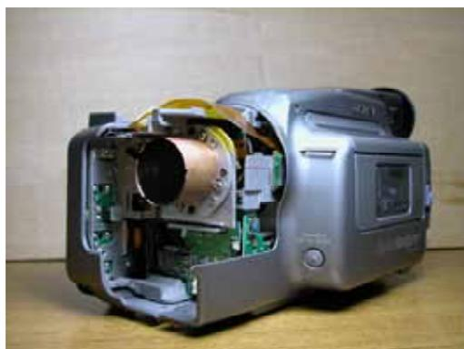
写真16 TF・CCD部分をカメラ本体に組み込んだ様子
