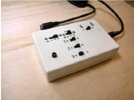
写真 19 シャッタースピードコントロールパネル操作面
